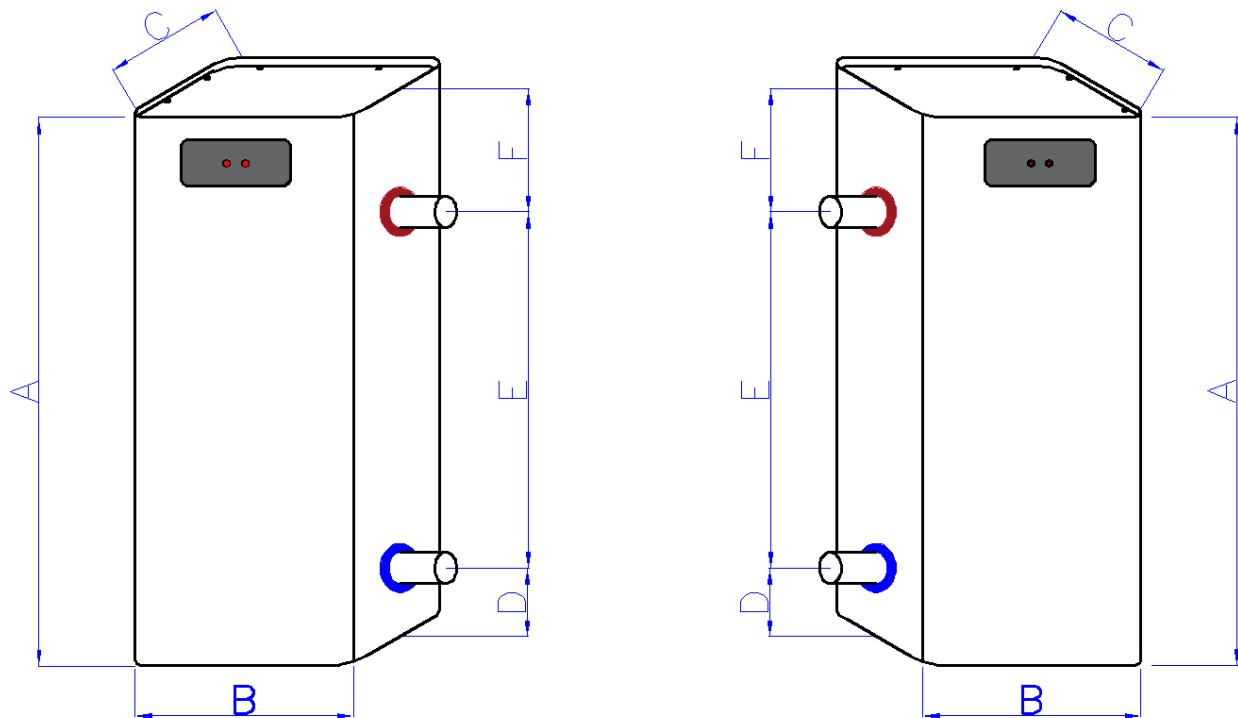
Slika 1a: Dimenzije kotla TK-eLG 6kW – model IP20 za unutrašnju montažu sa hidrauličnim priključcima sa desne ili leve strane
