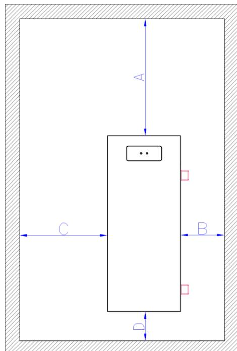
Slika 3b: Minimalne dimenzijs slobodnog prostora za model sa hidrauličnim priključcima desno
