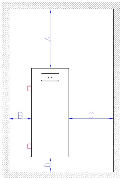
Slika 3a: Minimalne dimenzijs slobodnog prostora za model sa hidrauličnim priključcima levo
