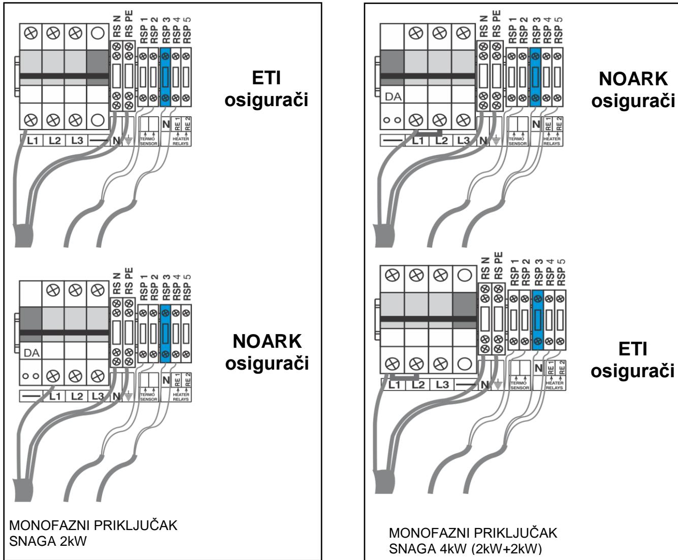
Slika 7a: Šema priključivanja kabla za monof. napajanje
