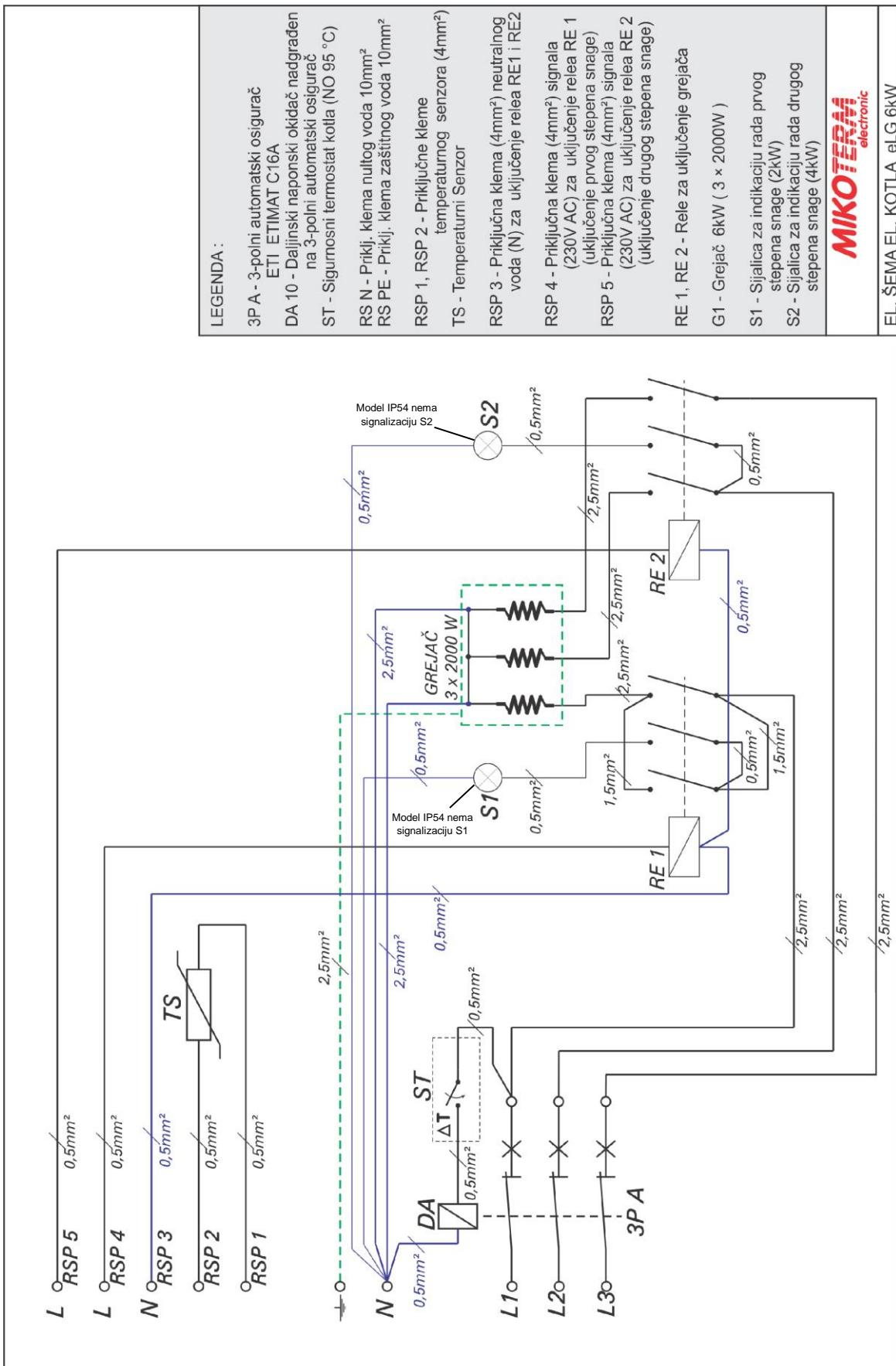
Slika 8: Električna šema kotla TK-eLG nominalne snage 6 kW
