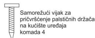
Samorežući vijak za pričvršćenje plastičnih držača na kućište uređaja komada 4
