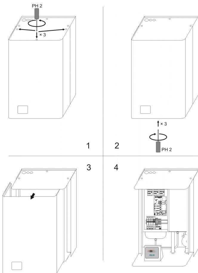
**Slika 4 :** Otvaranje kotla (demontaža prednje oplate)
