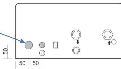
I set uvodnica (glavni set) se nalazi sa donje strane uređaja. Nalaze se na donjoj ploči uređaja u zadnjem levom uglu (vidi sliku 6). Namjenjeni su za povezivanje uređaja kada napojni kabal dolazi sa donje strane kotla.
