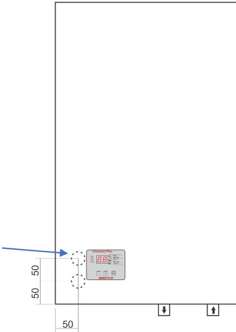
II set uvodnica je na zadnjoj strani uređaja, i namenjen je kada su na vreme pripremljeni kablovi u zidu i kada je već pripremljeno mesto za kotao. Oni omogućavaju da direktno iz zida napojni kabal uđe direktno u kotao. Kada se skine prednji poklopac vide se u donjoj levoj strani dva otvora dimenzije 28 mm postavljeni jedan iznad drugog. Ovakav način povezivanja osigurava estetsku funkciju, jer se kablovi ne vide (pogledaj sliku 6).
