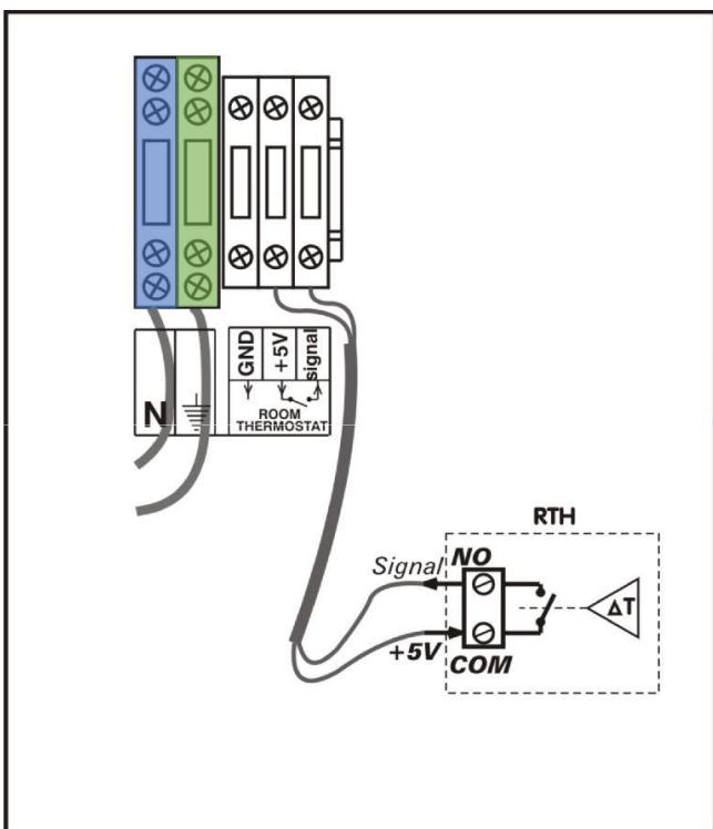
**Slika 10:** Shema priključenja digitalnog programabilnog
